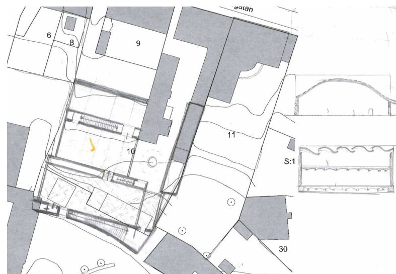
4. Murarna anpassas efter tomtstrukturen. Det stora rummet läggs i mitten av byggnaden för bättre rundgång.
