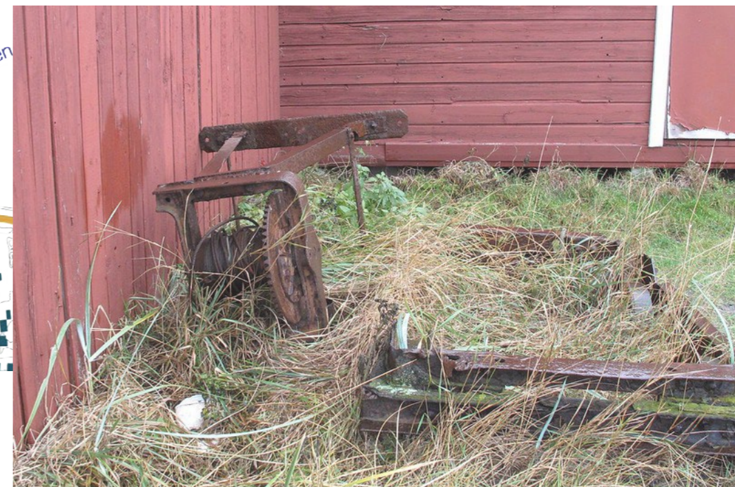
Figur 99. Rödmålad fasad med vita detaljer. Den gamla vinschen användes för att dra upp båten på land.
