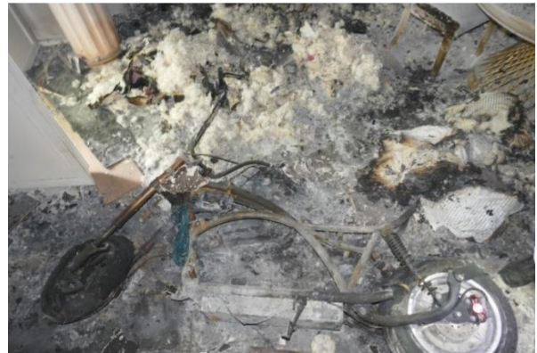
Figur 4-20, Fatbiken som är förstörd av branden och madrassen i vardagsrummet.
