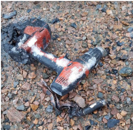
Figur 4-25. Skruvdragaren som har brunnit.
