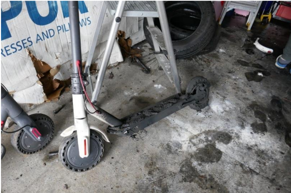
Figur 4-32. Elsparkcykeln som var startobjektet för branden.
