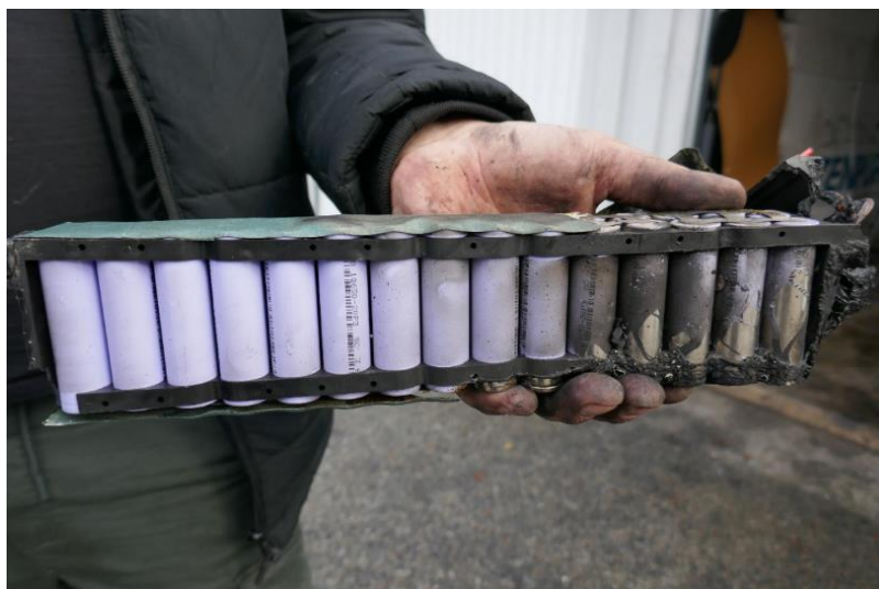
Figur 4-35. Uttaget batteri från elsparkcykel där termisk rusning har skett.
