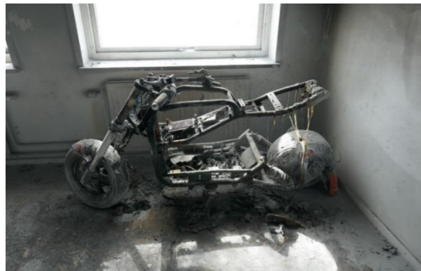
Figur 4-24. Fatbiken som har varit startobjektet för branden i lägenheten.
