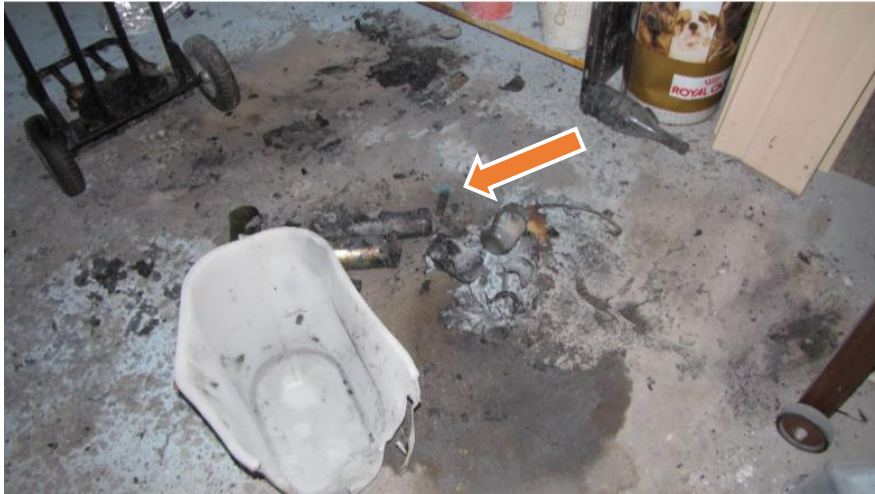
Figur 4-30. I mitten av figuren på finns det battericeller som har skjutits iväg från batteriet.
