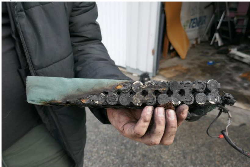
Figur 4-34. Uttaget batteri från elsparkcykel där termisk rusning har skett.
