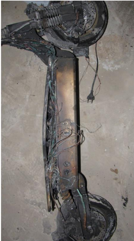
Figur 4-27. Batteriet i elsparkcykeln som har svullet upp under brand.
