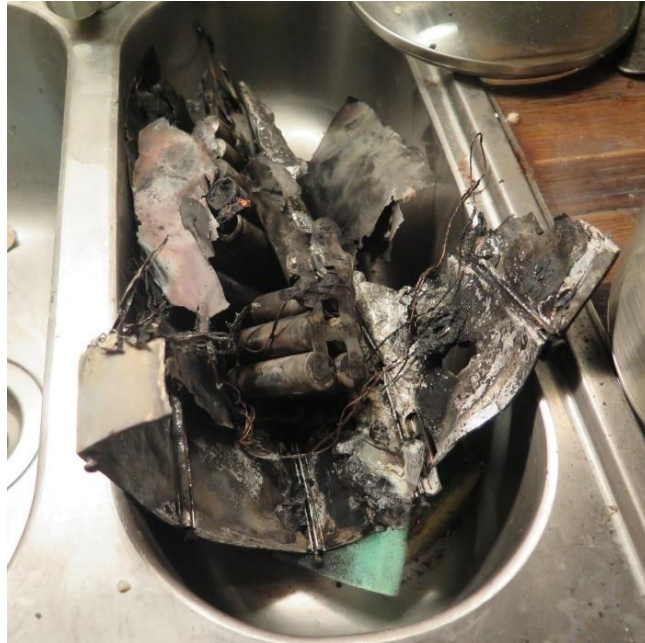
Figur 4-40. Batteriet som brunnit som har flyttats till en vask.
