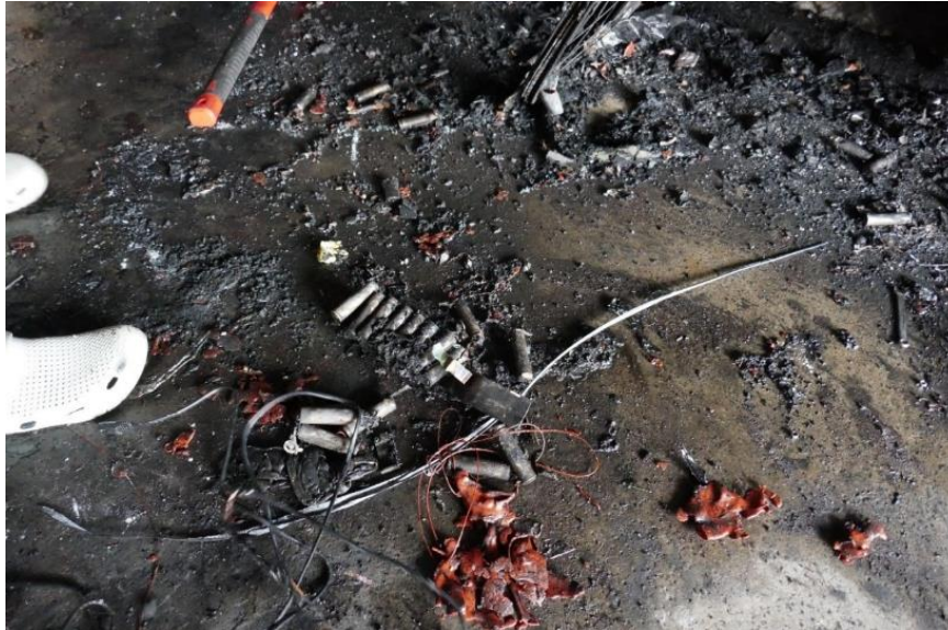
Figur 4-33. Battericeller som ligger på garaggolvet har skjutits iväg från elsparkkelen
