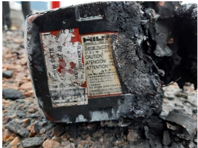
Figur 4-26. Batteriet till skruvdragaren.
