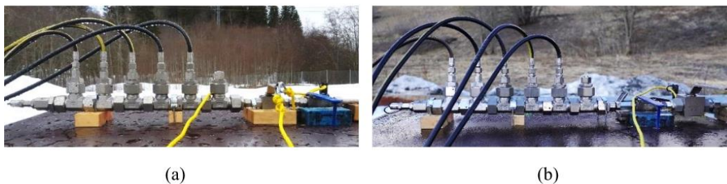
Figur 15. Två typer av uppställningar av grenrör för vätgasflödet. (b) gäller för experiment J45-2p-b, J45-5p-b, J90-2p-c och J90-5p-b.
