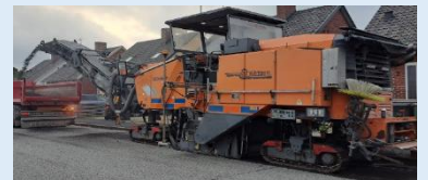
Fräsningsmaskin i Trelleborg.
