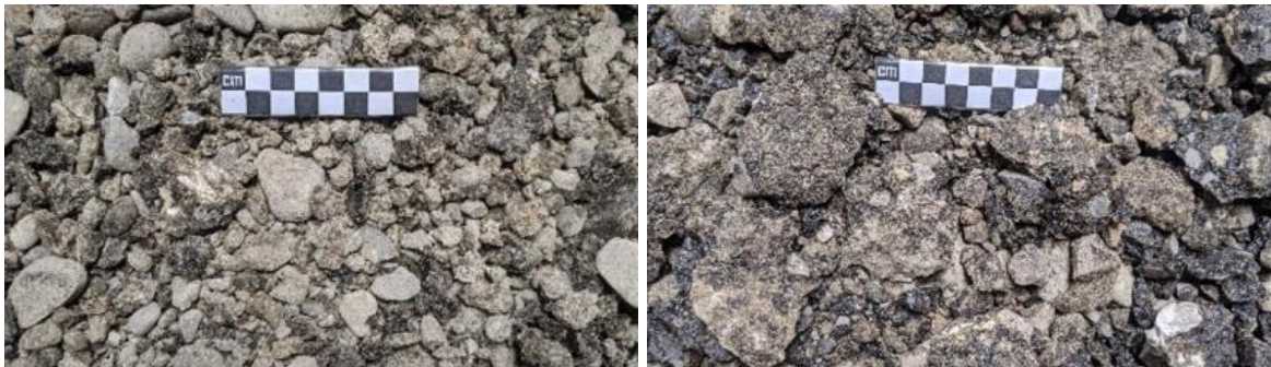
Figur 30: Till vänster index 87 och till höger index 172, en större skillnad kan tydas (Zaumanis etc, 2023).
