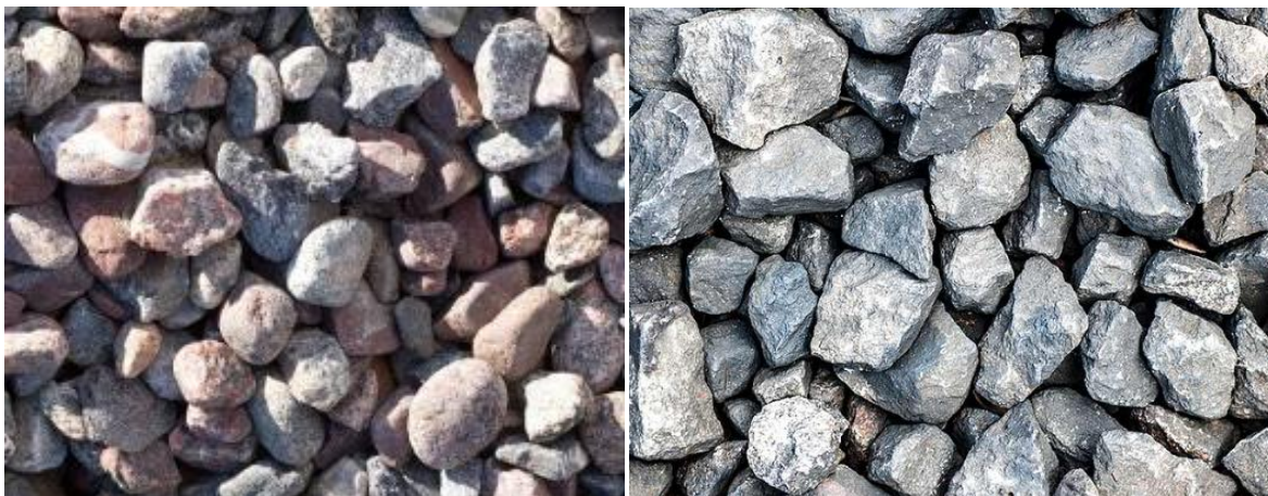
Figur 7: Naturgrus till vänster och sprängsten till höger, en tydlig skillnad kan tydas med den rundare formen på naturgrus.
