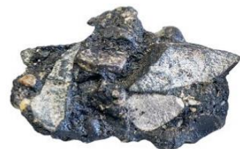
Figur 31: Nedbruten ballast (Zaumanis etc, 2023)
