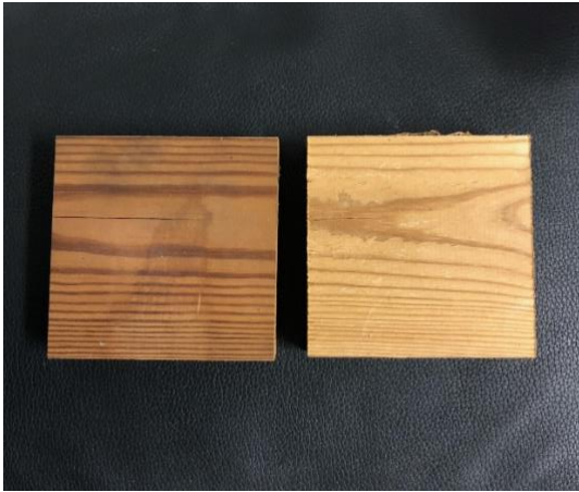
Figur 33. Bild som visar nyansskillnad mellan ej väderexponerat brandimpregnerat trä (vänster) och 11 veckors exponerat brandimpregnerat trä (höger)
