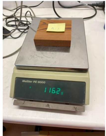
Figur 16. Bild som visar vägning av provbit A1
