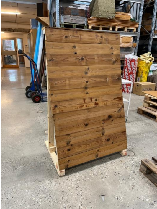
Figur 9, Bild på ställning med paneler av brandimpregnerat trä
