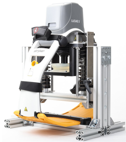
Fig. 1. Testutrustningen LISA III med den mekaniska hjärt-och lungräddningsmaskinen LUCAS monterad på.
