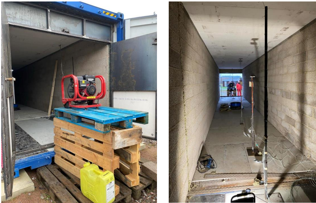
Figur 9 - Försöksuppställning för fläkten (vänster), plattermoelementen och ett termoträd (höger).
