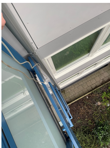
Figur 4.7 Slangen för uteluftstrycket hängdes ner från balkongen ca 1 meter ut i utemiljön och inte inne på balkongen.
