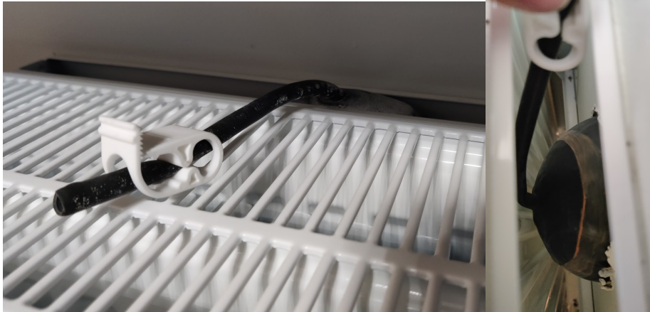
Figur 4.3. Exempelfoto på uppblåst tätningsballong som användes. Här i en tilluftskanal bakom radiator i yttervägg i en renoverad lägenhet.
