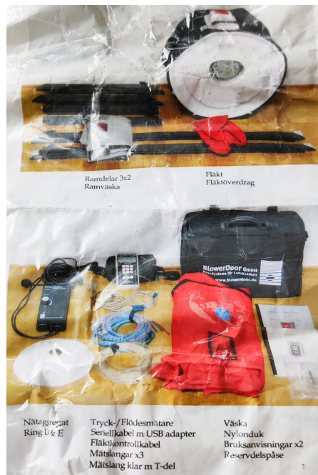
Figur 4.1. En bild ur instruktionsboken över samtlig utrustning som ingick och användes vid lufttäthetsprovingen.
