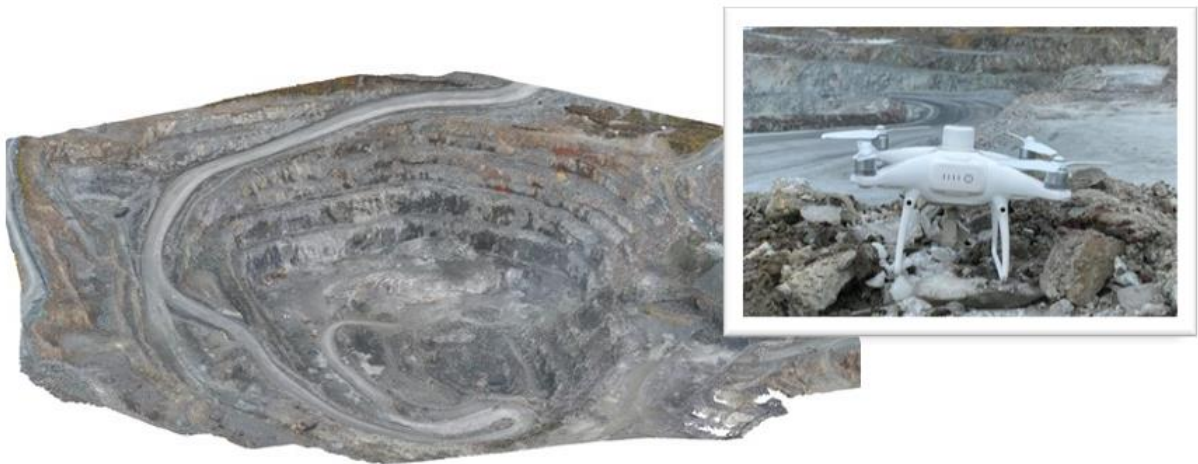
Vänster: 3D-modell över dagbrottet Tapuli. Höger: drönare som användes för insamling av underlag till modellen.
