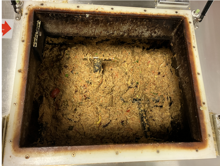
Figur 1: Matavfallet i en torkningsmaskin från Polhemskolan den 8 november efter blandning i 5 minuter med tömningsprogrammet (Foto: A. Woin).
