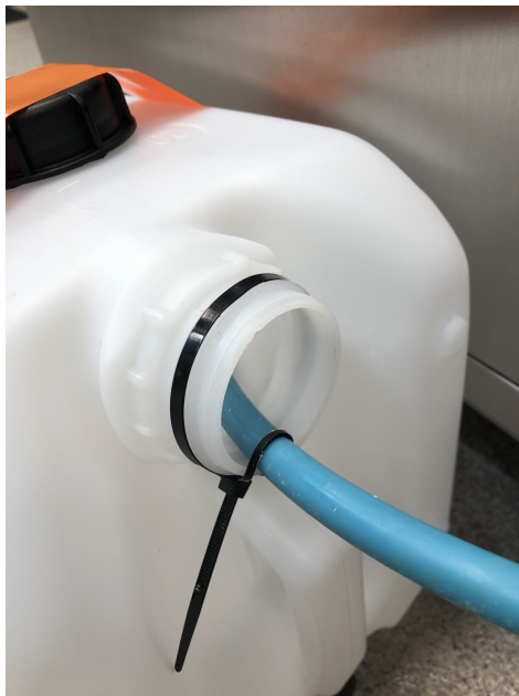
Figur 2: Slangen med kondensat från torkningsmaskinen fästes vid en 20 liters plastdunk (Foto: B. von Bahr).
