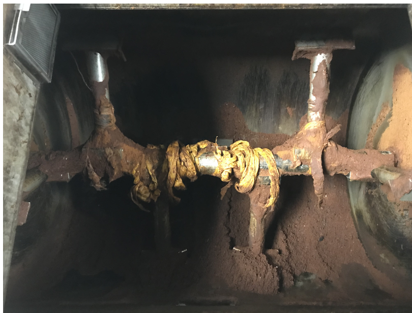
Figur 3: En liten mängd torkat matavfall finns kvar i trumman efter att torkningsprogrammet har körts. I detta fall hade någon form av icke organiskt avfall också slängts ner i torkningsmaskinen (Foto: A.Woin).
