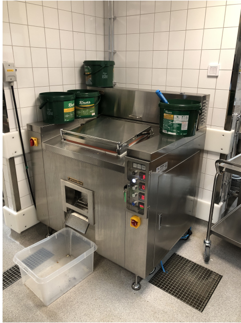
Figur 7: En Greenbox GB100 med kapacitet för 100 kg matavfall per torkcykel (Foto: B. von Bahr).
