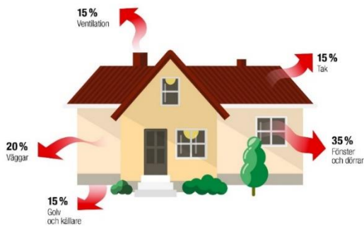
Figur 3-1: Värmeförluster i ett hus (Energimyndigheten 2023)
