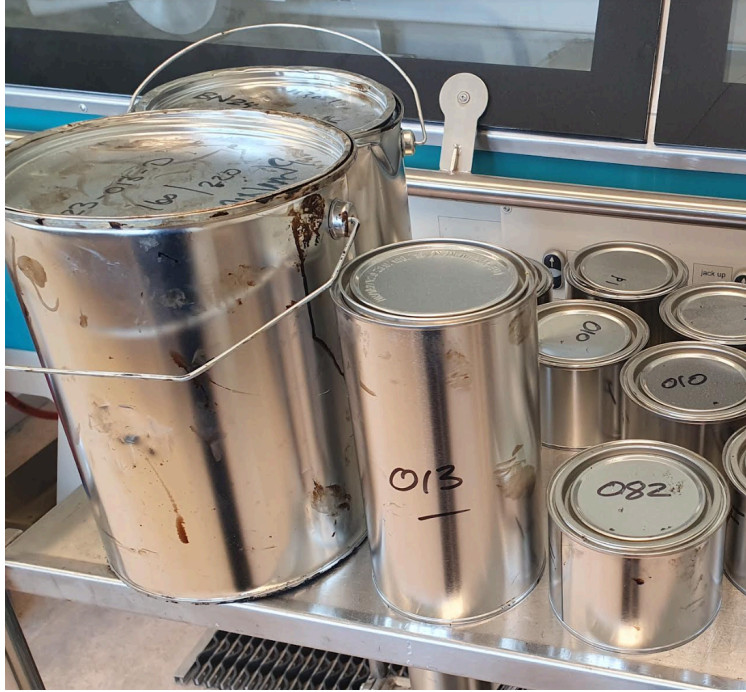
Figur 3. Samtliga burkstorlekar som användes under experimentet. Burkarnas volym börjar från vänster: 5010 \text{ cm}^3 , 1600 \text{ cm}^3 och 560 \text{ cm}^3 . Foto: Mark Smith.
