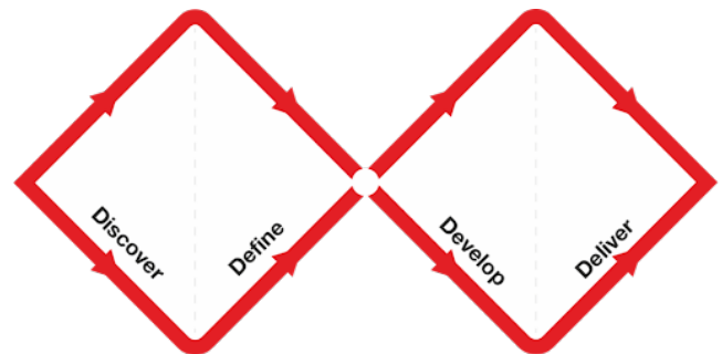
Figur 1. Schematisk bild som beskriver hur en Double Diamond-process går till. [7]
