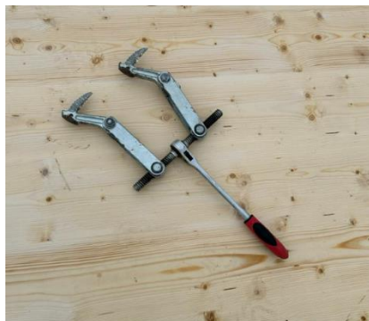
Figur 14. Verktyget skorpion som används vid montering av bjälklag (bild till höger Boman, 2024)
