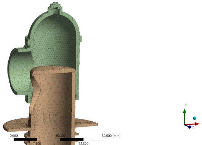
Figur 5.2: Mesh för montering kropp och ventil
