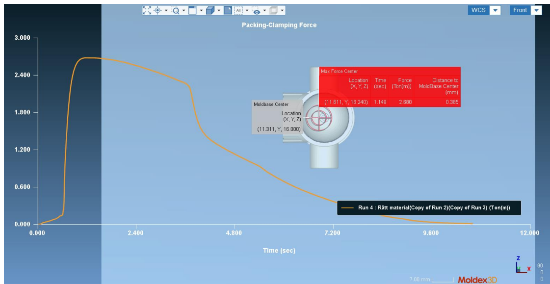
Figur 6.38: Clamping Force Centroid för den slutgiltiga ventilen
