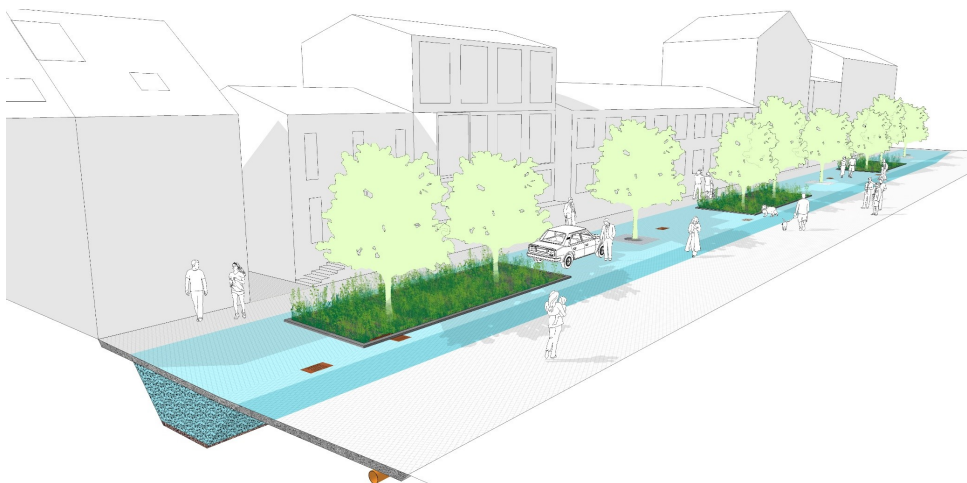
Figur 3.7: BGG-system med vattenfyllt öppet förstärkningslager. (Edge, 2024)
