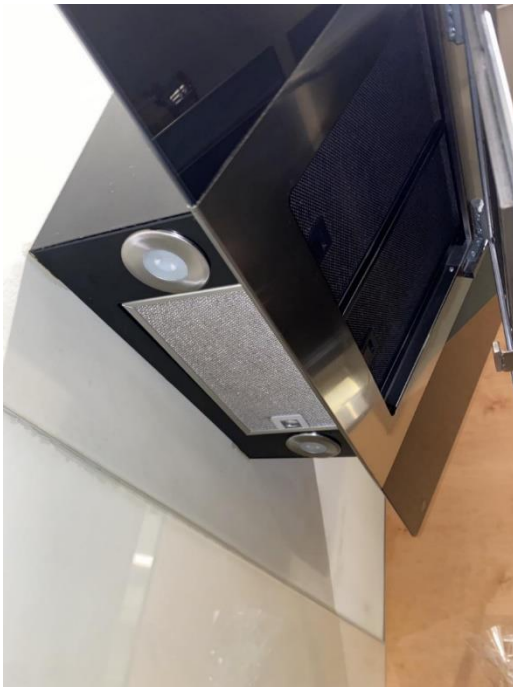
Figur 3.20 - Närbild på köksfläktens galler där lufthastigheten mäts med varmtrådsanemometern. Foto: Hellquist Lilja & Sandström.
