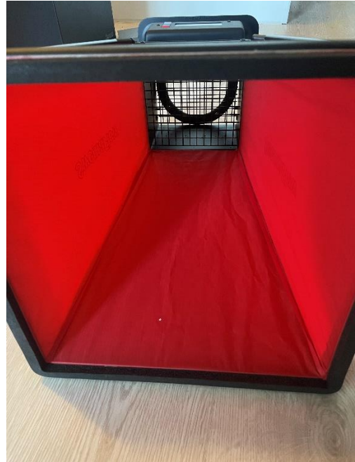
Figur 3.17 – Insidan av flödesstosen, modell SwemaFlow 126, med varmtrådar samt strypring. Foto: Hellquist Lilja & Sandström.
