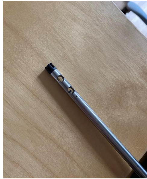
Figur 3.15 – Munstycke av varmtrådsanemometer där mätning av lufthastighet sker. Foto: Hellquist Lilja & Sandström.
