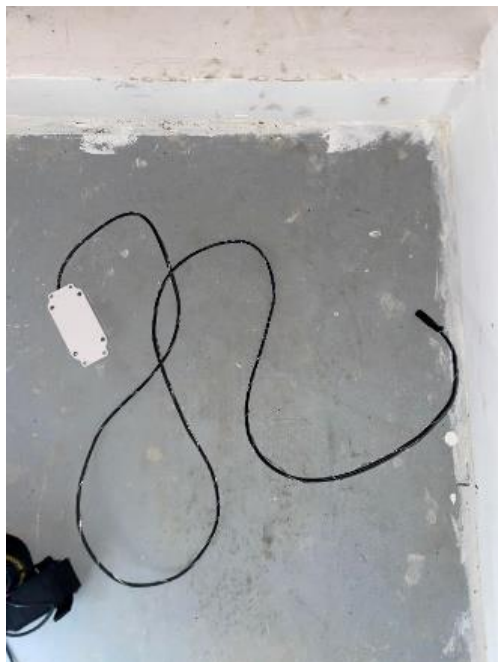
Figur 3.6 – Bild av sensor med förlängningssladd invirad i ståltråd för bättre stadga vid installation. Dessa benämns "B" och "C" i undersökningen. Foto: Hellquist Lilja & Sandström.
