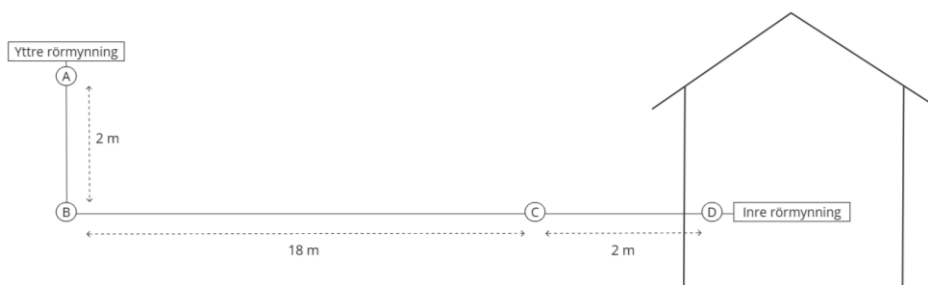
Figur 3.8 – Schematisk ritning över rörsystemets utformning med sensorernas placering. Punkterna A, B, C och D representerar de fyra olika sensorernas placering. Bilden är ej skalendig eller likvärdig verklig rördragning utan har i syfte att ge en bra överblick över fältundersökningens uppsättning.
