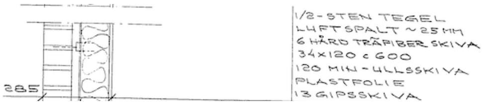
Figur 6.2 - Vägghkonstruktion på långfasad samt våning 4 på gavlarna.
