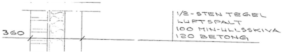
Figur 6.1 - Vägghkonstruktion gavelfasad, våning 1-3
