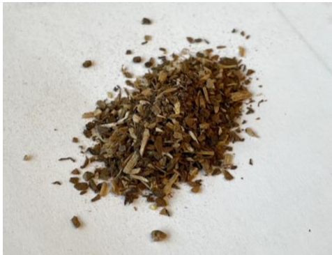
Figur 2. Finfördelad bark som råvara för tillverkning av bioolja.
