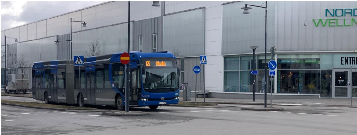
Figur 30: Mittförlagt busskörfält som är fysiskt separerat av en allé. Fotografiet är taget i anslutning till hållplatsen Stora torget, stombusslinje 175 i Barkarby/Stockholm.
