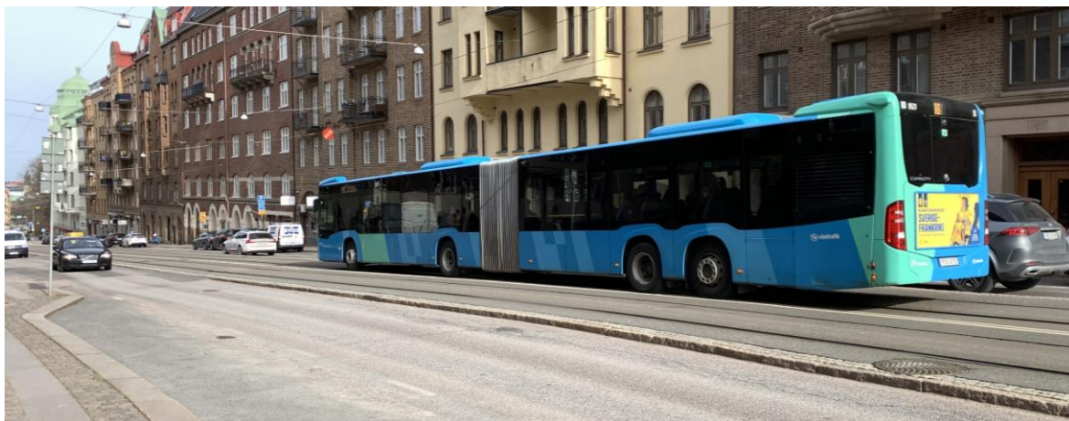
Figur 34: Fysiskt separerat busskörfält som delas med spårvägen. Fotot är taget vid Kapellplatsen, Göteborg.
