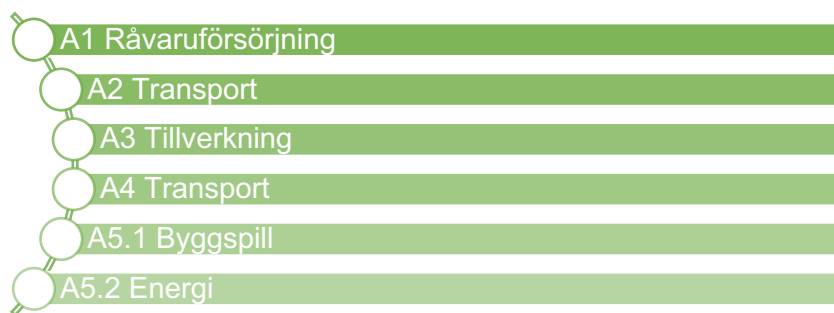
Figur 2. Ingående informationsmoduler i en klimatdeklaration enligt standard EN 15978, med tillägg enligt Boverkets klimatdeklaration, se modul A5.1 och A5.2.
