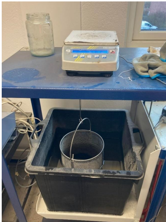
Figur 18: Vägning av provkropp under vatten.
