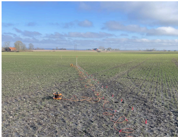
Undersökningsområdet Ladugårdsmarken där en resistivitetsmätning enligt foto utförs.
