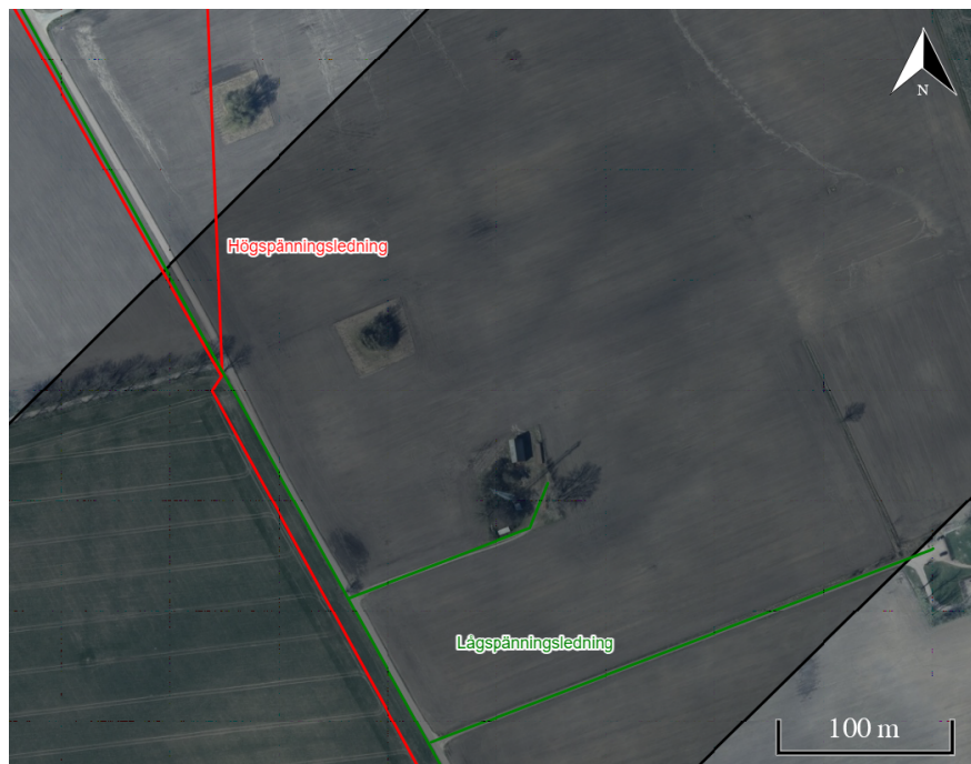
Figur 4.4: Högspänningsledning (röd) samt Lågspänningsledning (grön) inom undersökningsområdet. Bildkälla: ©Lantmäteriet (information från Ledningskollen)
