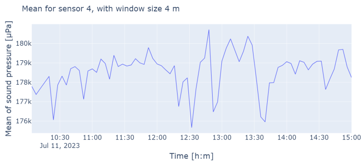
(d) The mean sound pressure using 4 minutes subwindows for sensor 4.
