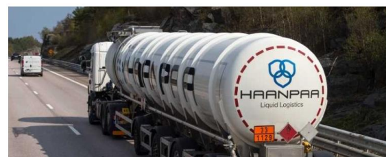
Bild på transport av farligt gods med orange skylt. Bild tagen från: https://www.borlange.se/fordjupadoversiktsplan-borlange/hansyn/miljostorande-verksamheter-och-farligt-gods
