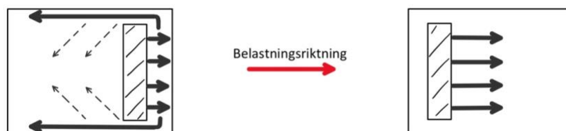
Figur 2.6: Lastöverföring friktionsplattor (planskiss).
