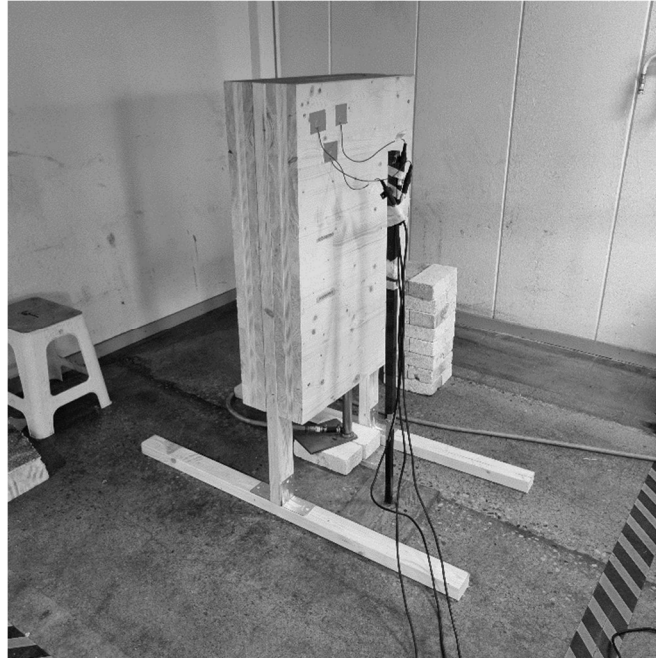
Figur 13 Uppställning av triangulering med förbränning i kavitet.
