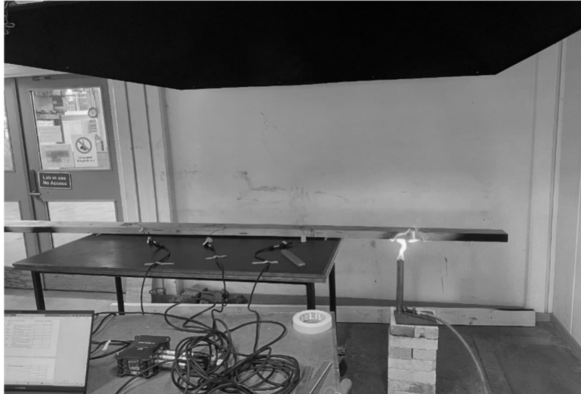
Figur 9 Uppställning för ljuddetektering vid förbränning av regel.
