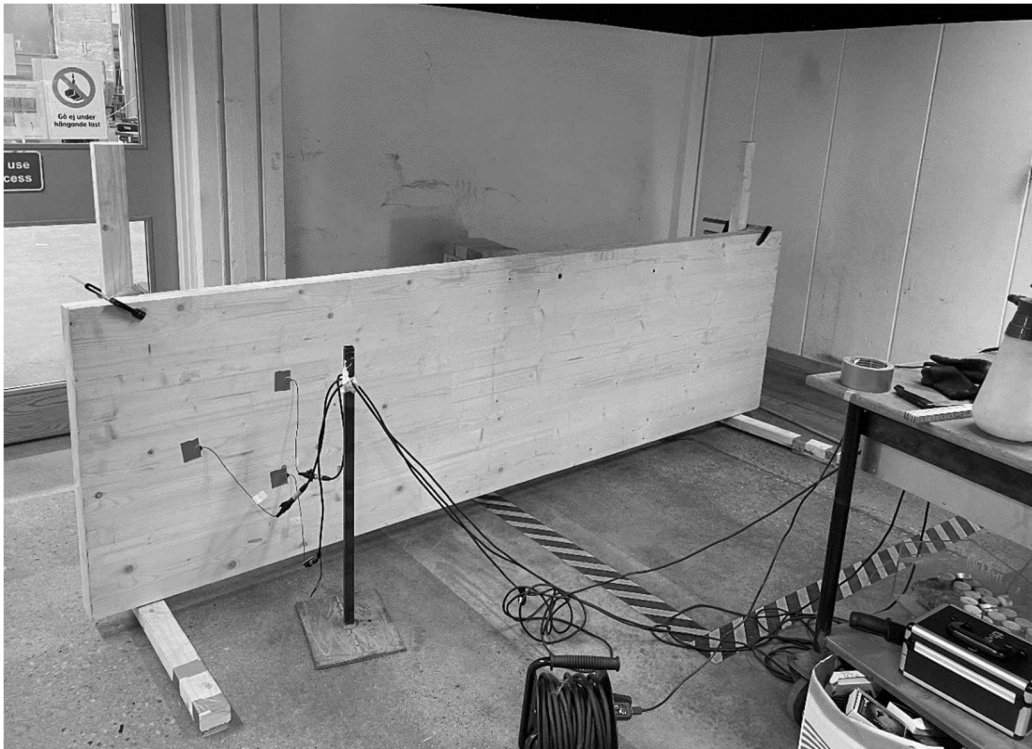
Figur 11 Uppställning av triangulering med förbränning med stor KL-träskiva. Här visas hur mikrofonerna placerats.
