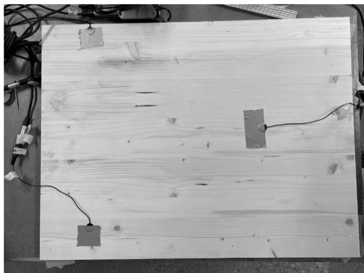
Figur 6 Uppställning av mikrofoner för triangulering på limfogskiva.
