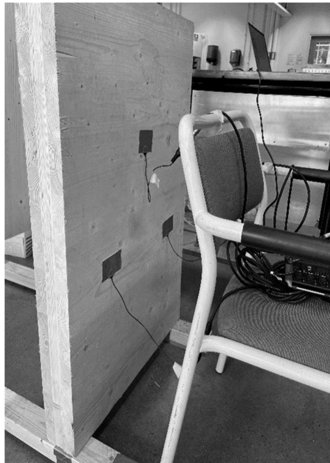
Figur 7 Uppställning av kontaktmikrofoner för triangulering för ljudkälla i liten KL-träskiva.
