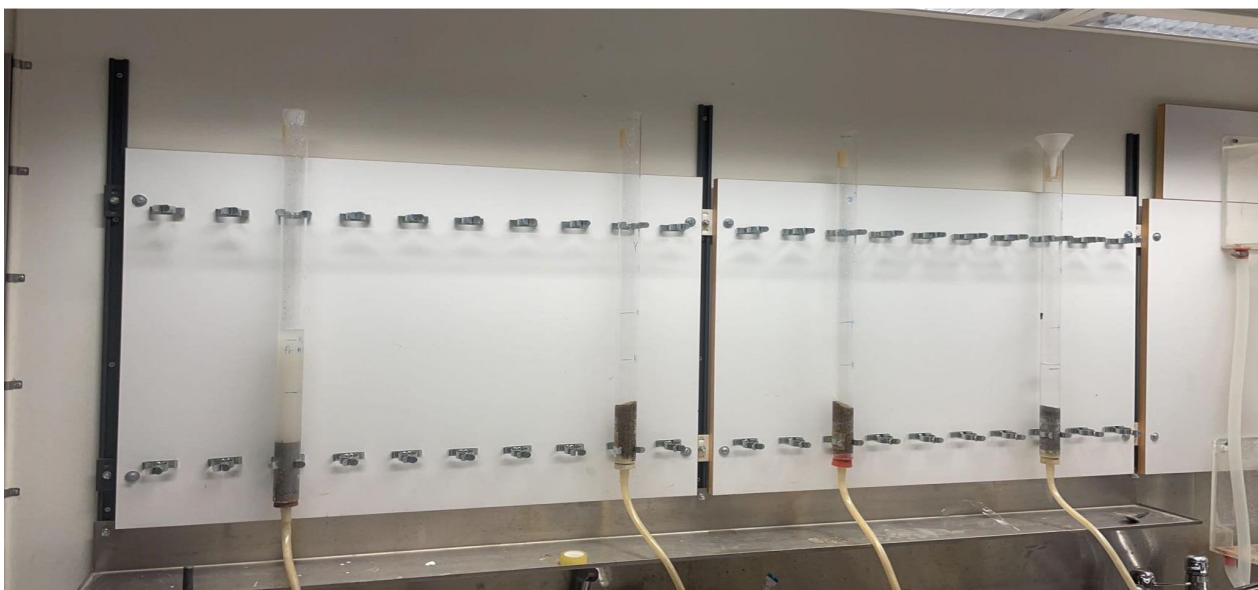
Fig. 3. Foto på uppställning för permeabilitetmätning. Tiden det tar för vattnet att passera 10 cm från två olika trycknivåer noterades i detta experiment. Foto taget av Musa, 2024.
