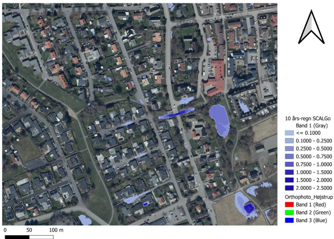
Figur 19: Översvämningsutbredning SCL vid 10-årsregn.
