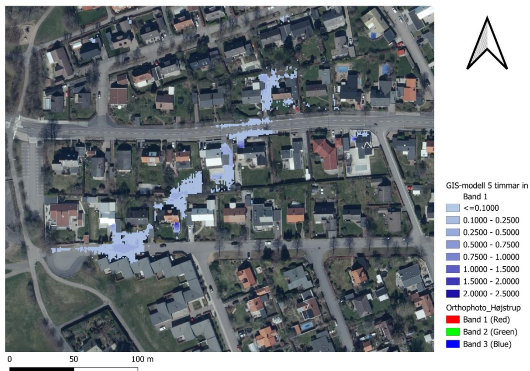
Figur 23: Översvänningsutbredning Pluvioflow vid 10-årsregn 5 timmar in.
