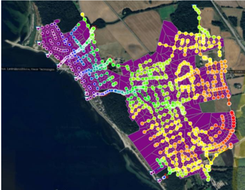
Figur 9: Ledningsnätmodell med avrinningsområden över Hittarp/Laröd (Mike+).
