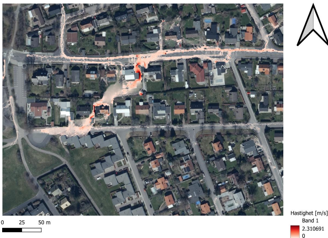
Figur 28: Vattenhastigheter efter 5 timmar i Pluvioflow.
