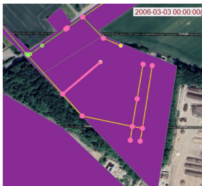
Figur 16: Översvämmade noder (rosa) i ett enskilt avrinningsområde.
