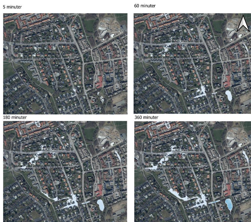
Figur 27: Vattnets utbredning vid 5, 60, 180 och 360 minuter.
