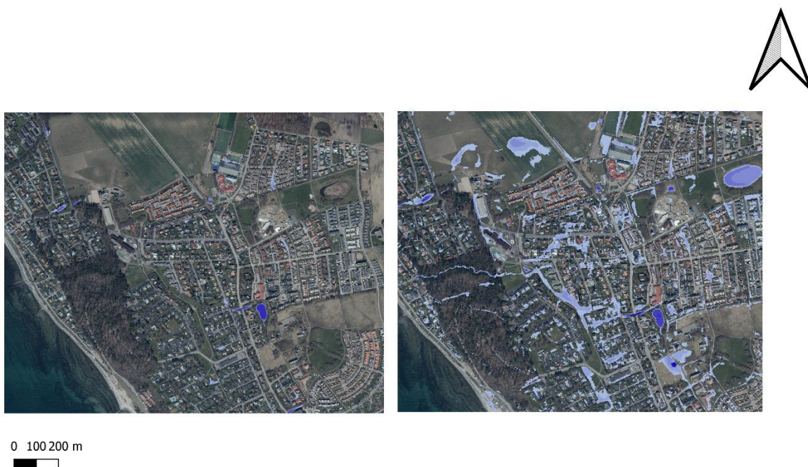
Figur 26: Jämförelse mellan 100-årsregn med statiskt modellerad upptryckning(vänster) och en kopplad 2D-1D modell (höger) med 100-årsregn.
