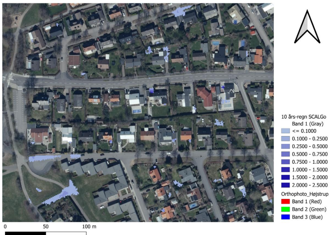
Figur 22: Översvänningsutbredning SCALGO vid 10-årsregn.
