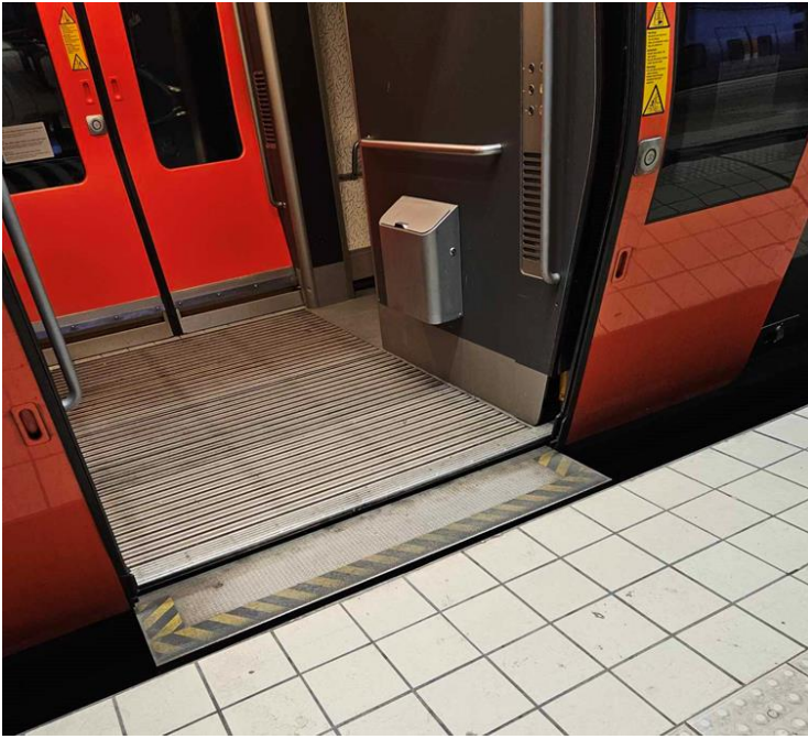
Figur 9: Bild från platsbesök över höjden på tågets entréer utan trappsteg. Källa: Matilda Sebelius
