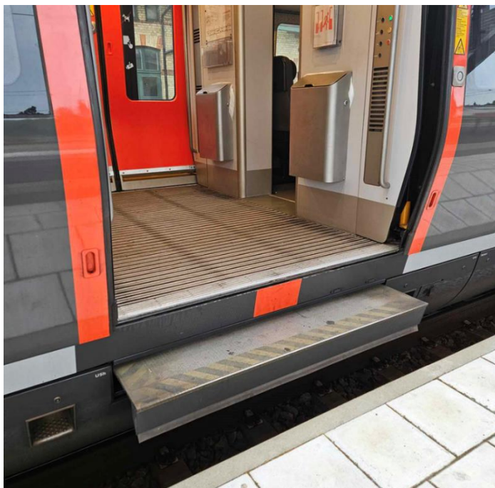
Figur 8: Bild från platsbesök över höjden på tågets entréer med trappsteg. Källa: Matilda Sebelius
