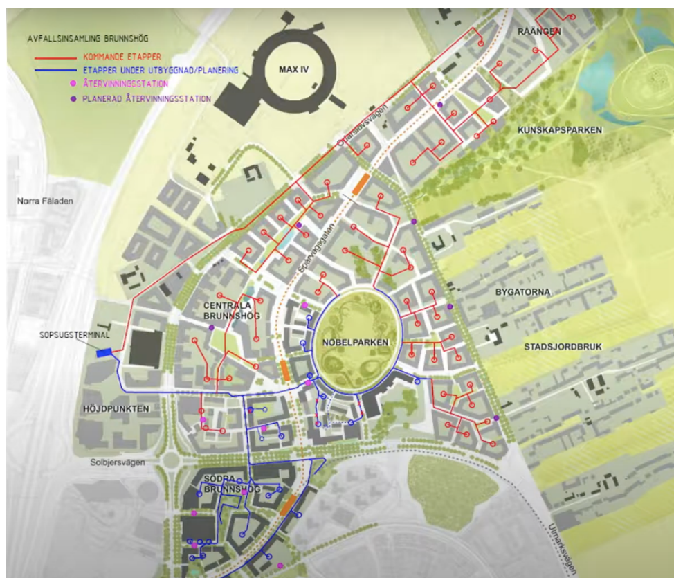
Figur 1: Planritning av Brunnshögs sopsugsystem [6].
