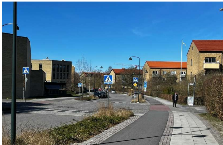
Figur 6.2 - Vanlig utformning av cykelpassage/överfart, Byggmästaregatan-Vävaregatan
