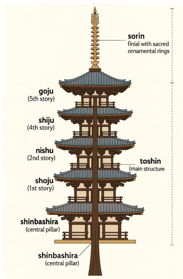
Figur 20. En illustration av Horyu-ji, som visar konstruktionens funktion kring den centrala pelaren (shinbashira). Illustration: Egen illustration.
