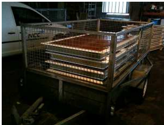
Figur 4.1 Släpvagn för transport av dörrar från mellanlager till monteringsplats. 180
