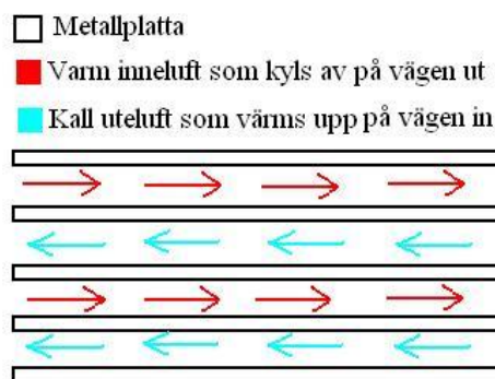
Bild 2. Principiell figur över hur ett FTX-system fungerar.
