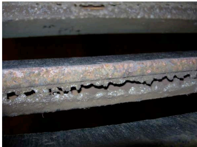
Figur 11: Sönderbränd kolslitsskena pga ljusbåge (Foto: Olofsson, A)
