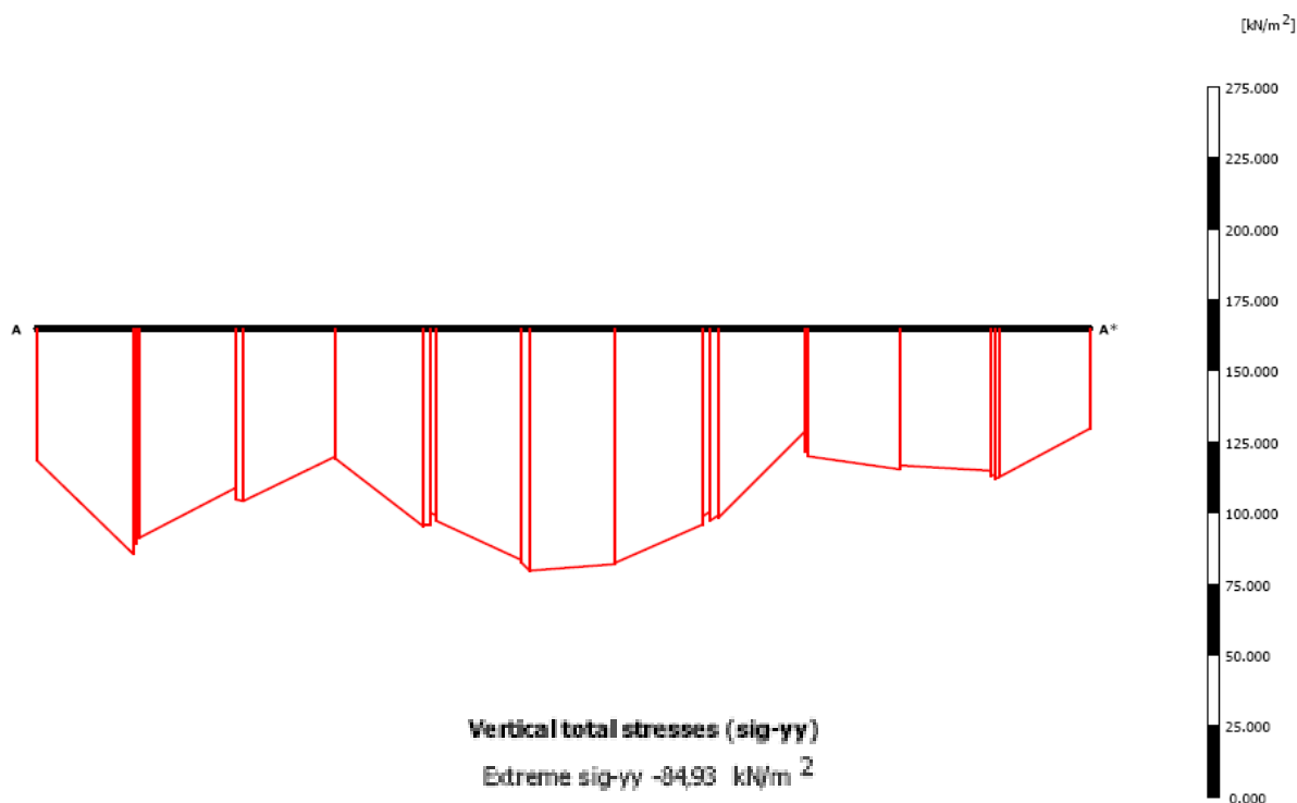
Figur 21 Kontakttryckfördelningen i snitt 2
