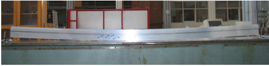
Figur 4.16: Stora plastiska deformationer.
