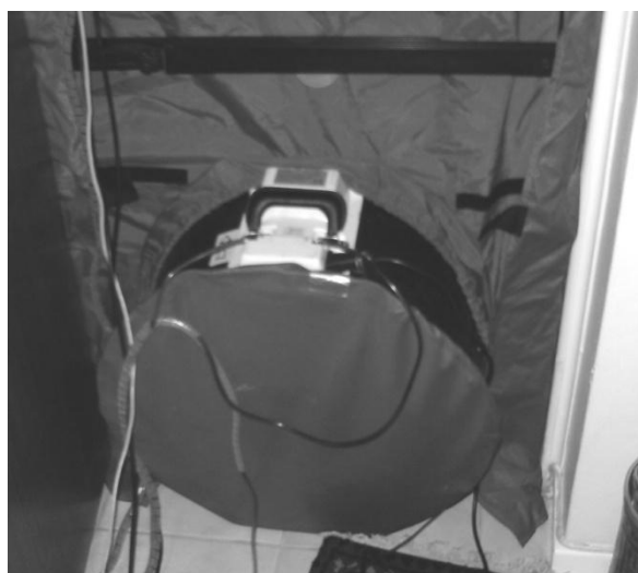
Bild 7 och 8 visar tryckprovningensutrustningen innan fläkten monterades in i hålet i underkant och sedan fläkten monterad.
