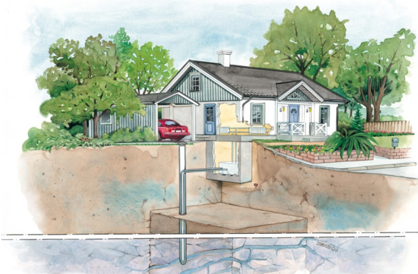
Fig. 2 Bergvärmesystem till enskild villa (Geotec).
