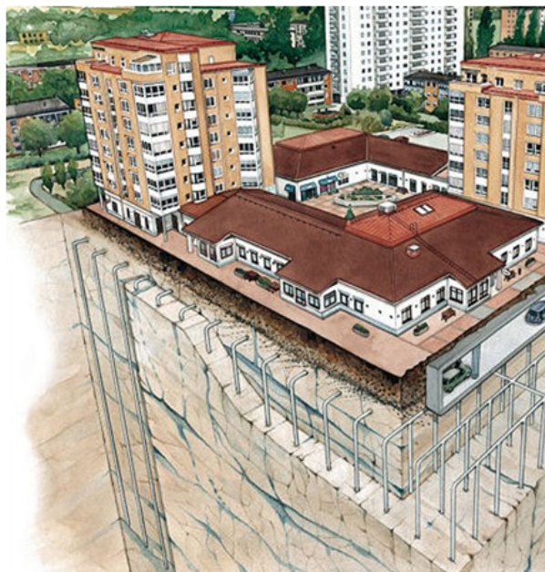
Fig. 3 Ett borrhålslager till en större fastighet ( www.geotec.se ).
