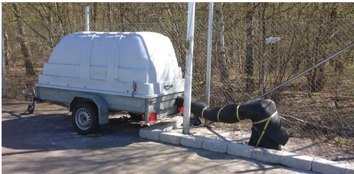
Figur 17. TRT-mätning pågår på Pål 1. Pålen och rören är isolerade. Foto: Simon Carlsson
