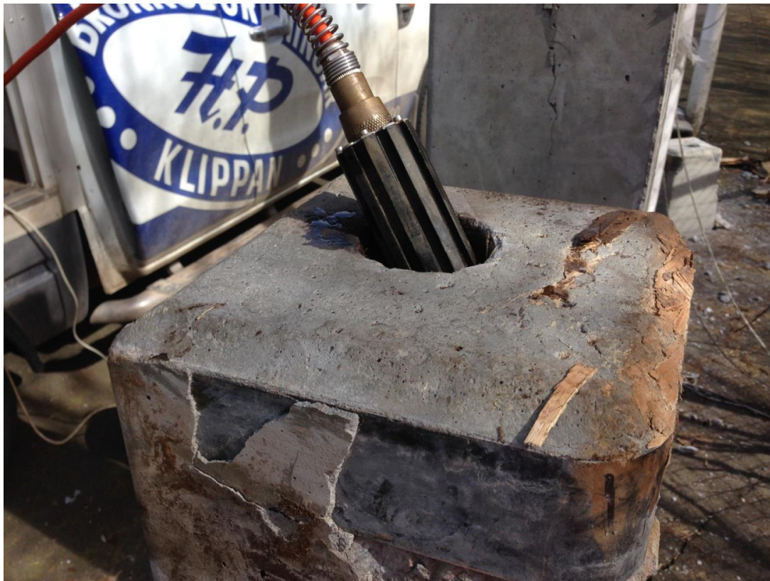
Figur 14. Filmning inuti pålarna med VLT, Video Logging Tool. Foto: Simon Carlsson
