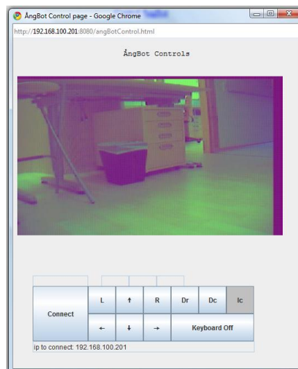
Figur 8.1: Användaren styr roboten från webbläsaren i datorn
