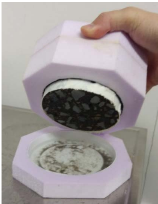
Figur 5 Prov vid avskalningsmätning. Skålen i botten innehåller saltlösning med avskalat material.
