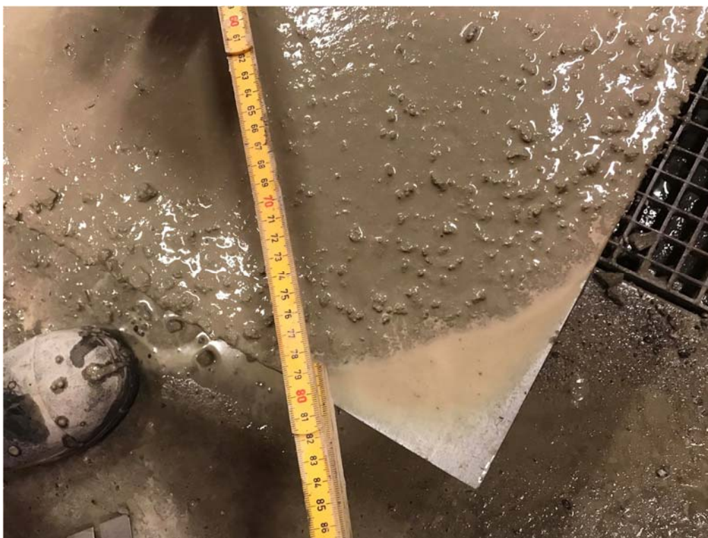
Figur 10. Utbredningsmått hos stenbetong, mätt till 79 cm i diameter.
