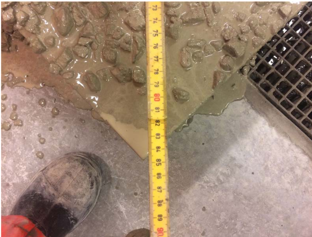
Figur 9. Utbredningsmått hos skumglasbetong, mätt till 82,5 cm i diameter.
