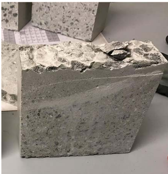
Figur 11. Tvärsnitt av en trycktestad kub av typen skumglasbetong. Tydlig avsaknad av stenballast i övre skiktet kan observeras
