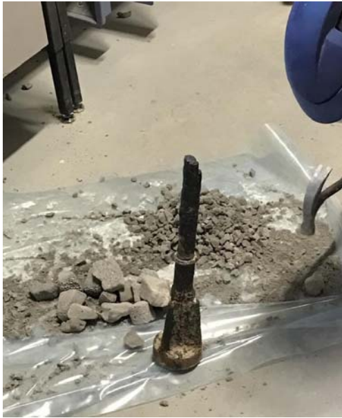
Figur 5. Skumglas i olika kornfraktioner under krossning för hand. Notera stoftet av skumglas som uppstått vid krossning.
