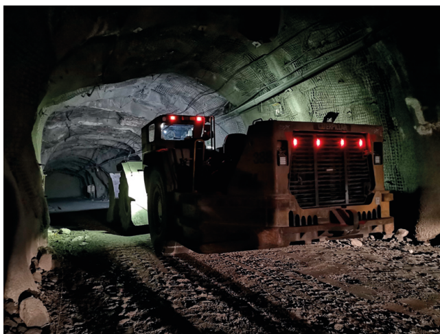
Bilden är tagen i en underjordsgruva där arbetsplatsmätningar utfördes. Underjordslastaren på bilden används för att transportera järnmalm. Vi utförde aerosolmätningar i omgivningsluften och i förarnas andningsszon.
