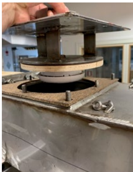
Figur 4. Montering av brandvarnaren då den placeras i provutrustningen.
