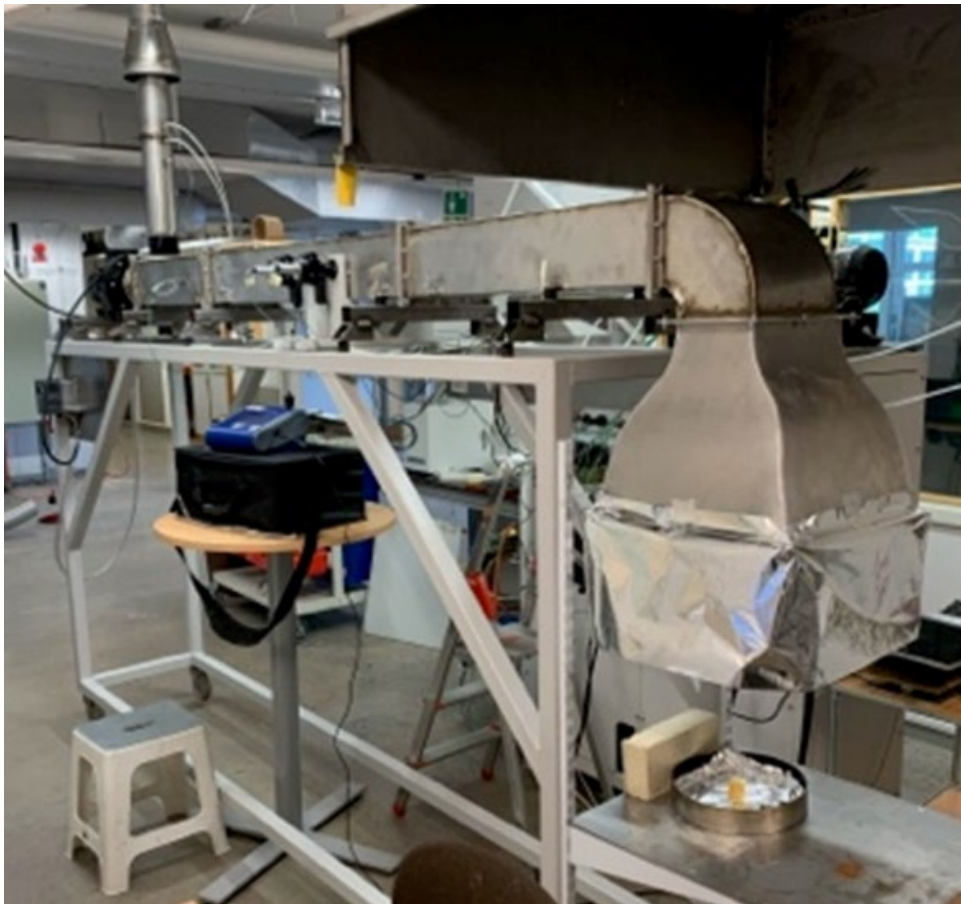
Figur 2. Provningsapparat med designbrand av flammande plast (bit av madrass tillverkad av polyuretan).
