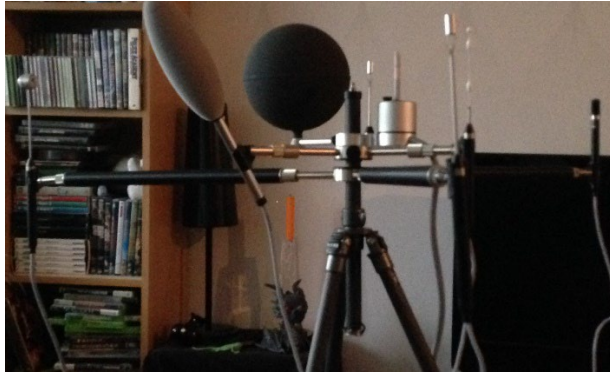
Figur 7.2 En fältmätning av termisk komfort inomhus med Innova datalogger och sensorer. (Foto: Chuansi Gao)
