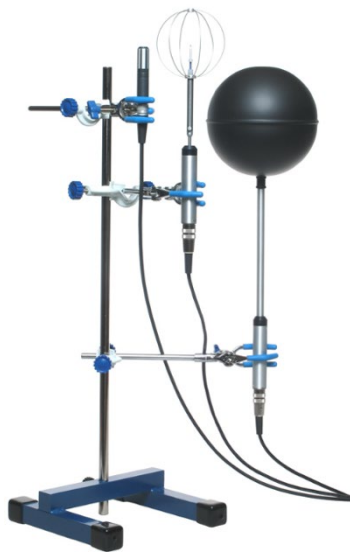
Figur 7.3 Swema-utrustning för mätning av termisk komfort inklusive mätningar av lufttemperatur, lufthastighet, luftfuktighet och svart globtermometer (som kan användas för att uppskatta medelstrålningstemperatur). (Källa: Swema 2022)
