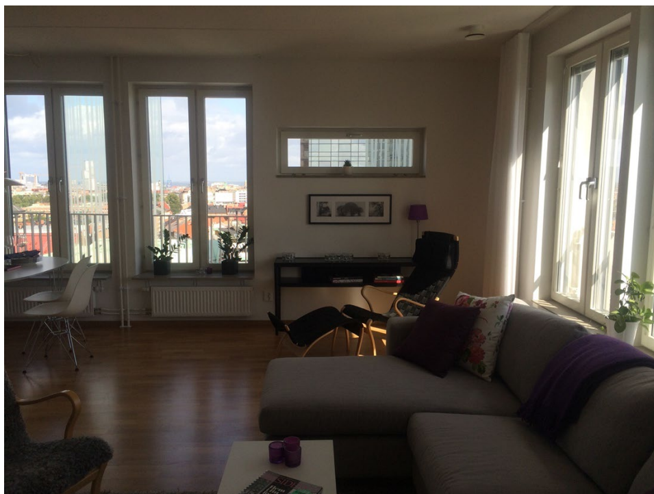
Figur 3.6 Interiör från modern lägenhet där fönster utförts som kopplade (1+2) med mellanglaspersienn i östligt väderstreck (till höger i bild) och utan persienner åt norr (fönstren till vänster i bild). (Foto Helena Bülow-Hübe)
